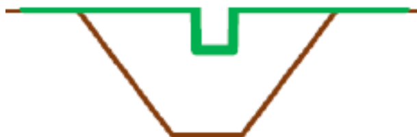
Figure 2 - En marron : lit du ruisseau avant travaux ; en vert : après travaux
